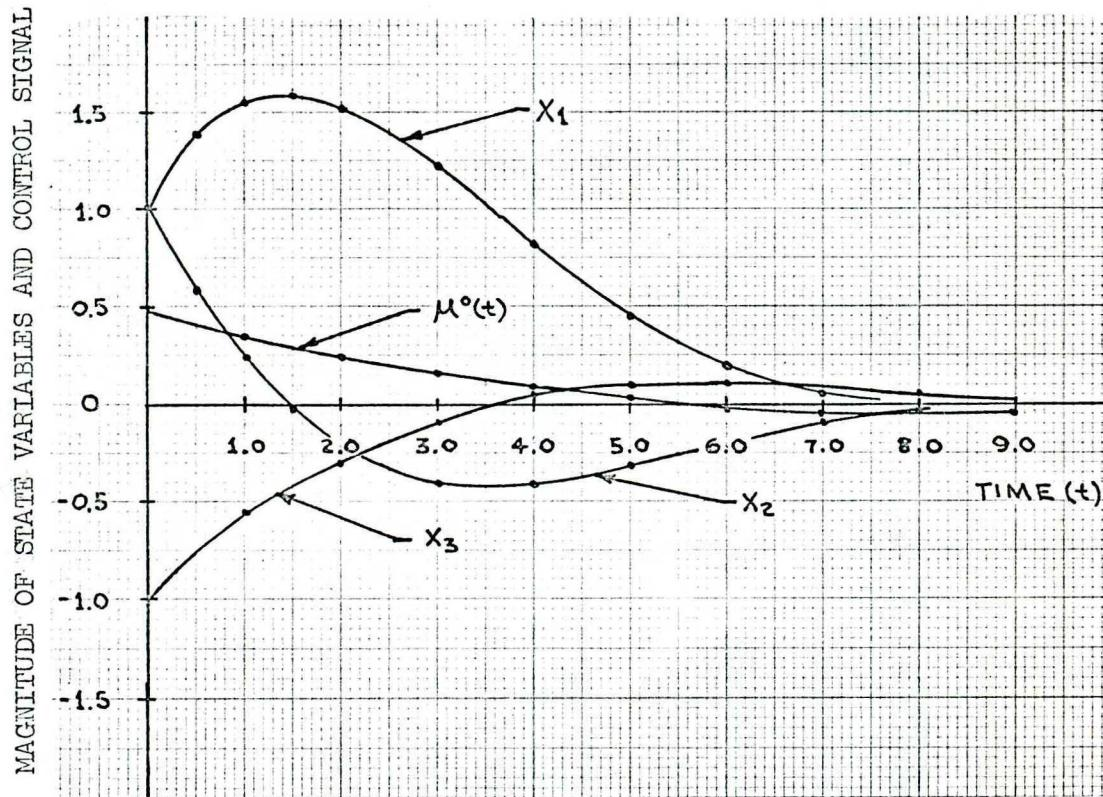
FIGURE 8 - STATE VARIABLES  $x_1$ ,  $x_2$ ,  $x_3$  AND OPTIMUM SIGNAL
