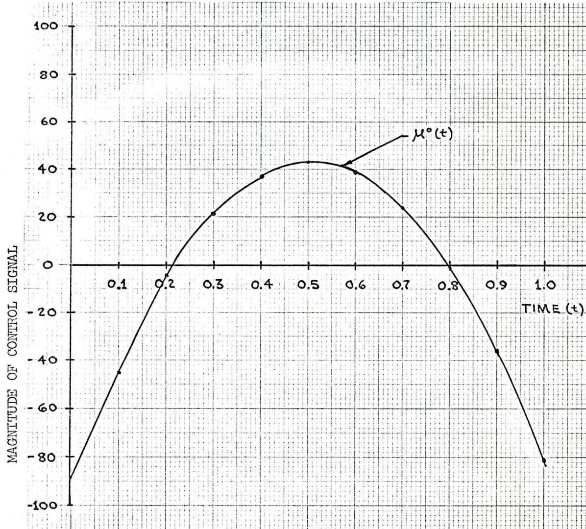
FIGURE 13 - OPTIMUM CONTROL SIGNAL  $u^o(t)$  VERSUS TIME  $t$ .
