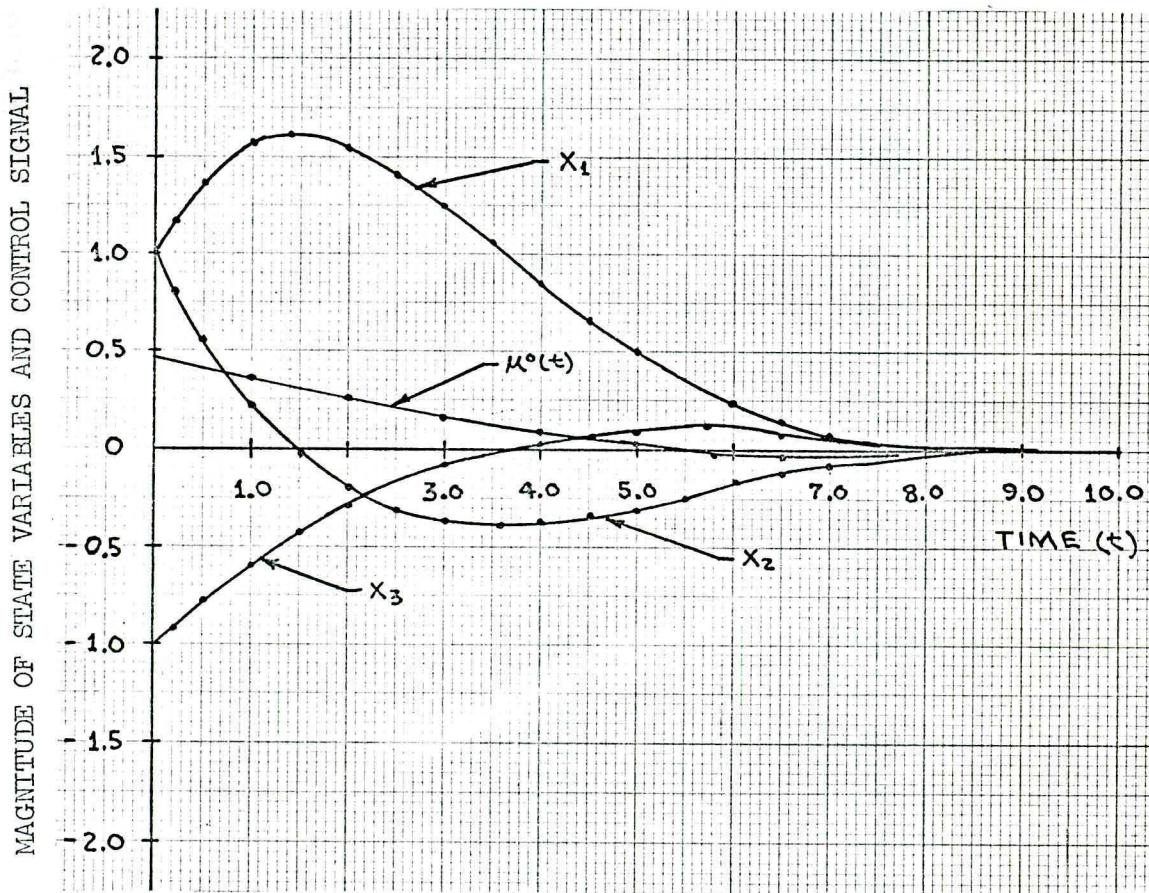
FIGURE 9 - STATE VARIABLES  $x_1$ ,  $x_2$ ,  $x_3$  AND OPTIMUM CONTROL
