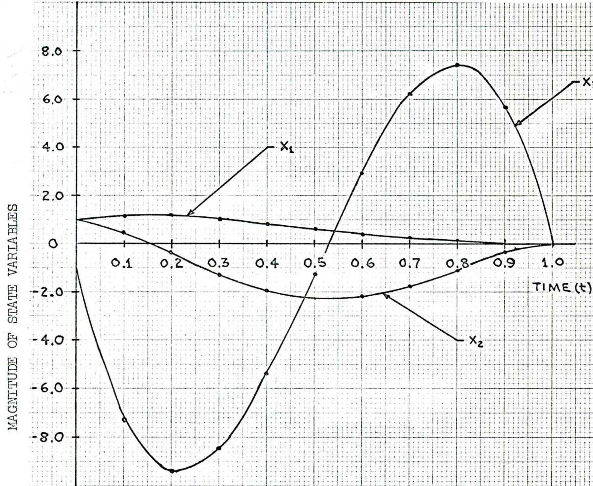
FIGURE 5 - STATE VARIABLES  $x_1$ ,  $x_2$ , AND  $x_3$  VERSUS TIME  $t$ .
