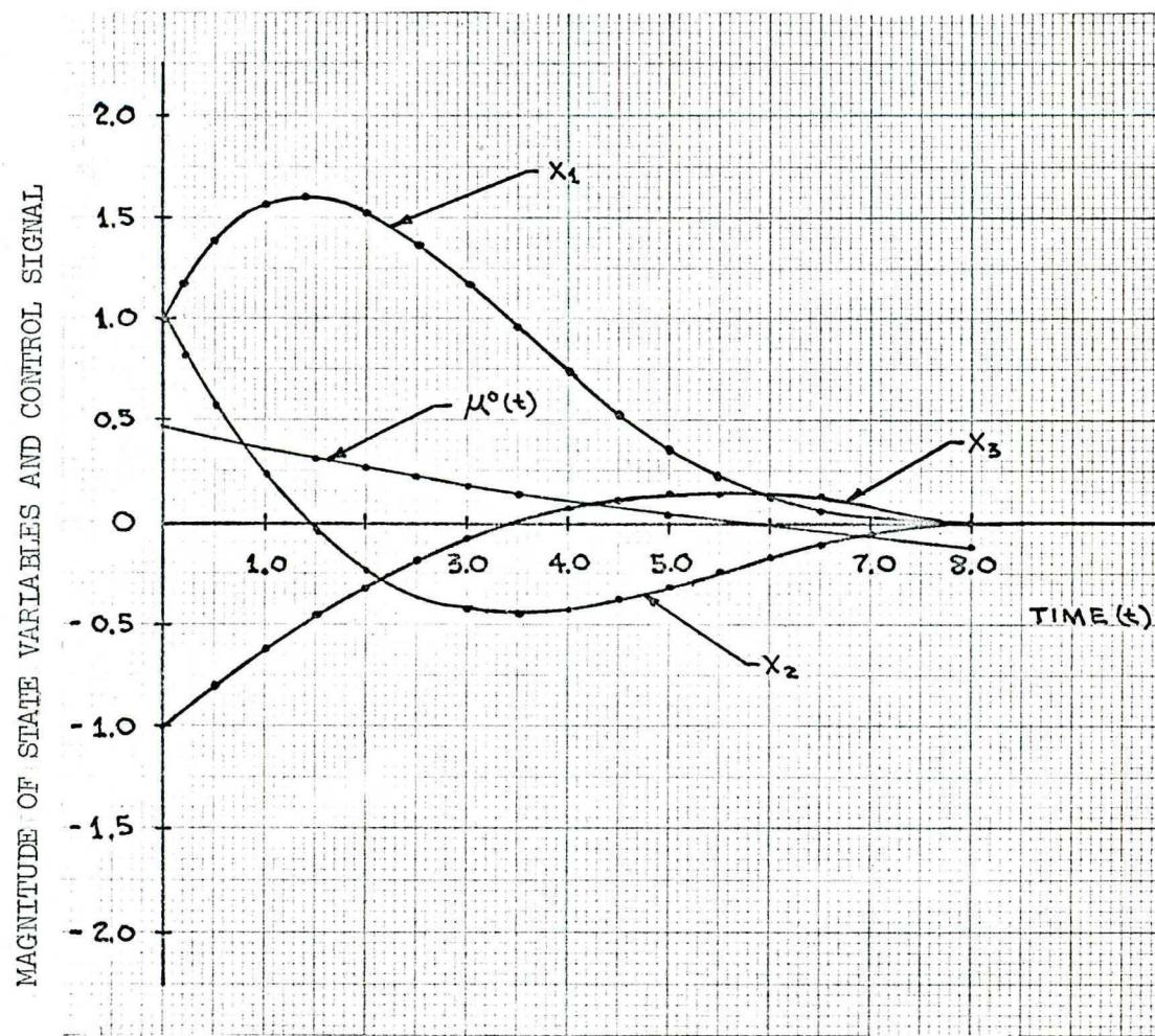
FIGURE 7 - STATE VARIABLES  $x_1$ ,  $x_2$ ,  $x_3$  AND OPTIMUM CONTROL
