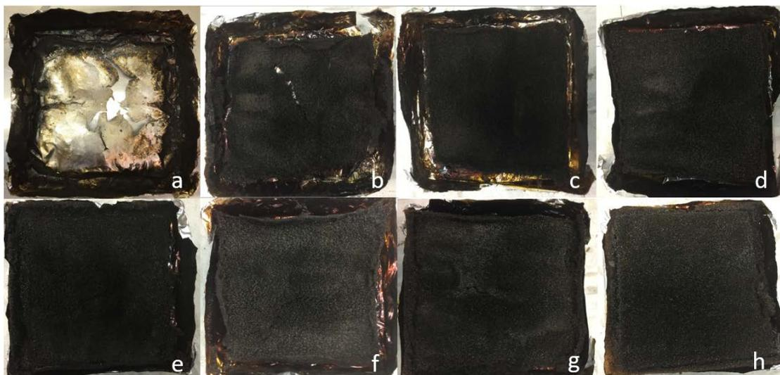
**Figure 1.6.** Digital photographs of residues after cone test: a) pure PU, b) PUL30, c) PUL40, d) PUL50, e) PUL60, f) PUL70, g) PUL80, and h) PUL90.
